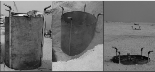
Bild 5: Stahlbehälter für den Großversuch
