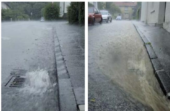
Abb. 4: Beispiele für Straßeneinläufe mit eingeschränkter Aufnahme der Abflüsse während eines Niederschlagsereignisses
