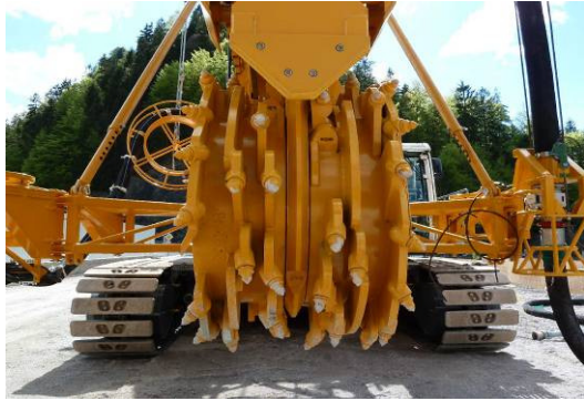
Abbildung 8 und 9: Fräse und Greifer zur Herstellung der 70 m tiefen Dichtwand
