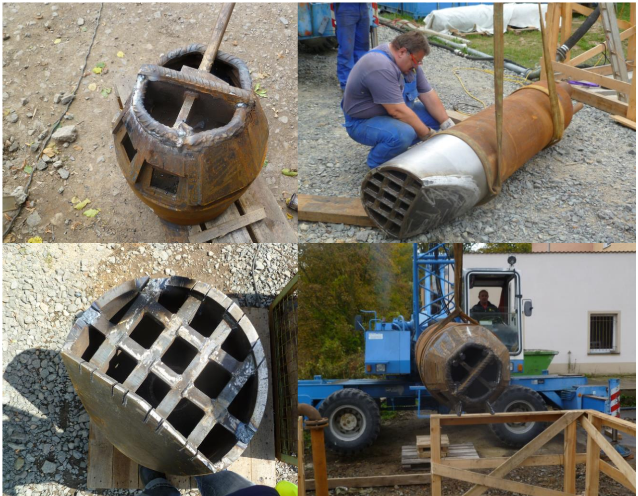
Abbildung 6-2 - Beispiele unterschiedlicher Bohrkopfausführungen
