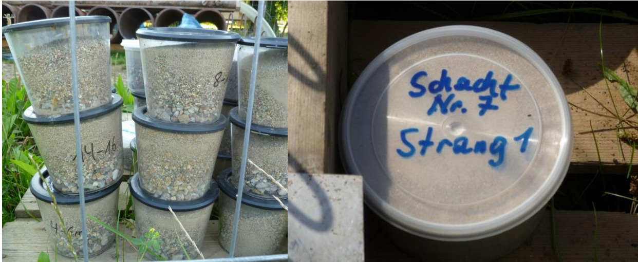
Abbildung 6-4 - Materialproben zur Filterbemessung
