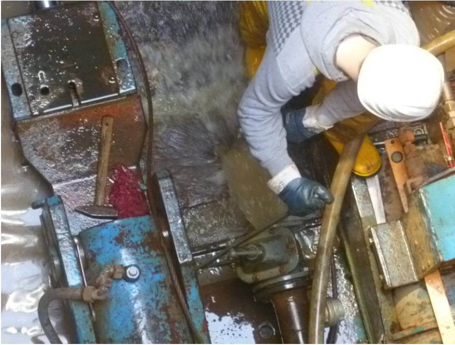
Abbildung 7-3 intermittierendes Lösen mit Spülwasserzugabe
