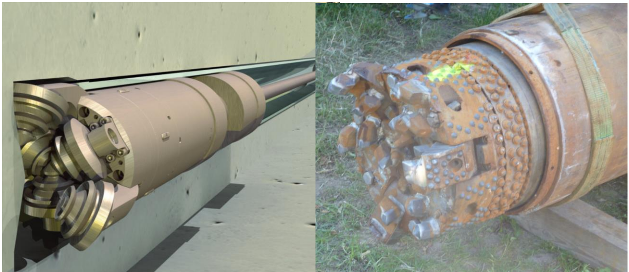
Abbildung 5-5 WHD-Bohrkopf (Bildquelle links: BHG Brechtel GmbH)
