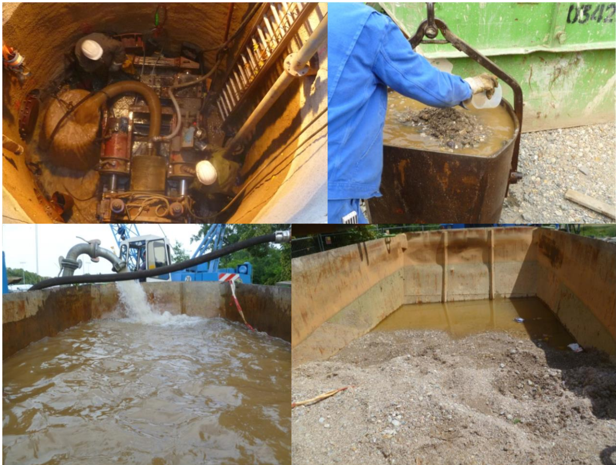
Abbildung 6-3 - Massenbilanz mittels Rückflussgut
