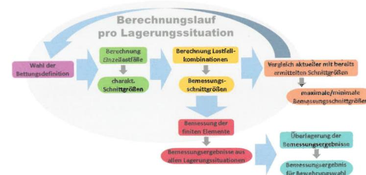
Bild 17: Aufbau der Berechnungsschleifen im T-Modell
