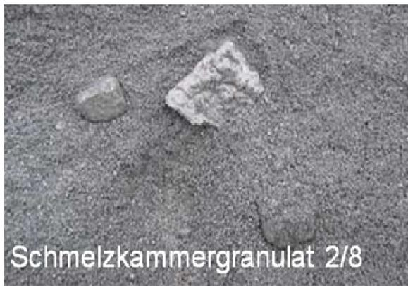
Abb. 15: (noch unaufbereitetes) Schmelzkammergranulat 2/8 mm
