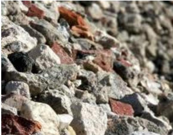
Abb. 7: RC-Baustoff als Trag-, Dränschicht
