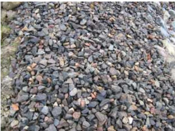
Abb. 14: Gleisschotter 32/56 mm als Stützkeil
