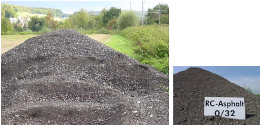
Abb. 6: aufbereiteter Ausbauasphalt als Trag-, Dränschicht
