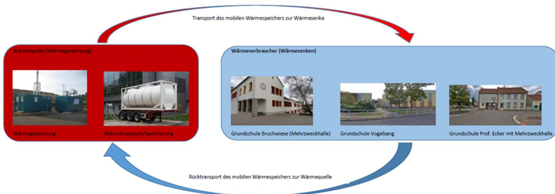
Abbildung 4. Schematische Darstellung mobiler Wärmetransport zwischen Wärmequelle und Senke
