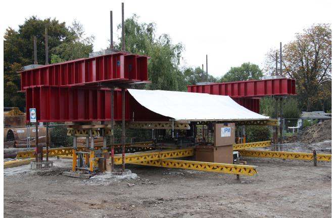
Bild 4: Belastungseinrichtung für statische Probelastung von Bohrpfählen
