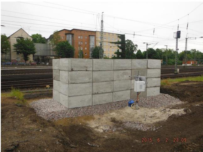
Bild 7: Belastungskörper zum Nachweis der statischen Gebrauchstauglichkeit des Erdkörpers der neuen Bahnanlagen
